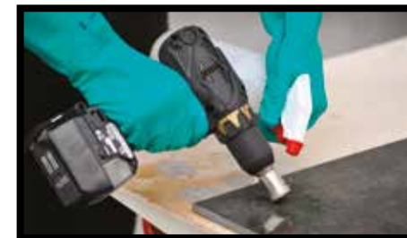
Fig.9/10 - In alternativa è possibile l'utilizzo di frese a tazza (o foretti) montate su smerigliatrici, trapani elettrici o avvitatori a batteria.
