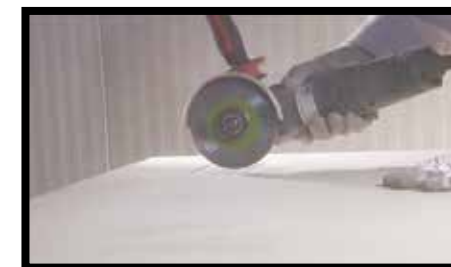
Fig.13 - È altresì possibile ottenere i medesimi risultati con dischi per carteggiare applicabili alla smerigliatrice manuale.
