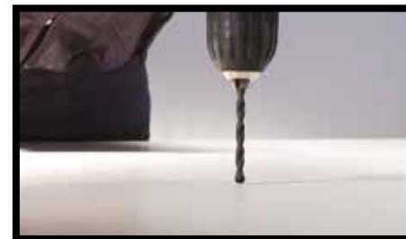
Fig.8 - Per la foratura manuale si possono utilizzare punte al tungsteno fino ad un diametro di 10 mm montate su trapani elettrici o avvitatori a batteria.
