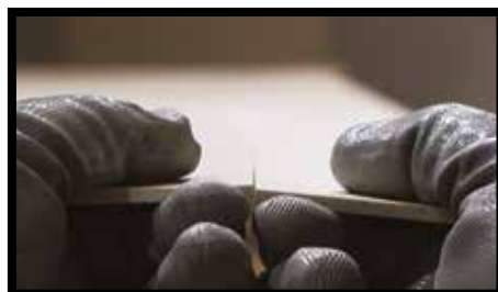
Fig.3 - Una volta praticata l'incisione è sufficiente una semplice flessione per ottenere il distacco dei due pezzi.
