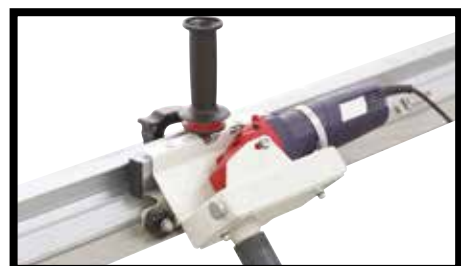
Fig.6 - Con la riga tagliapiastrelle è possibile utilizzare delle smerigliatrici manuali inserite in un'apposita intelaiatura, che si "infilano" sulla guida di taglio. In questo modo si possono realizzare sia tagli a 90° che a 45° per ottenere smussi e jolly.
