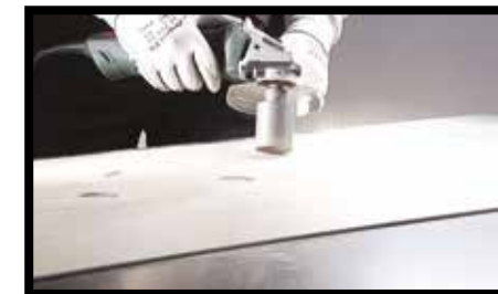
Fig.9/10 - In alternativa è possibile l'utilizzo di frese a tazza (o foretti) montate su smerigliatrici, trapani elettrici o avvitatori a batteria.
