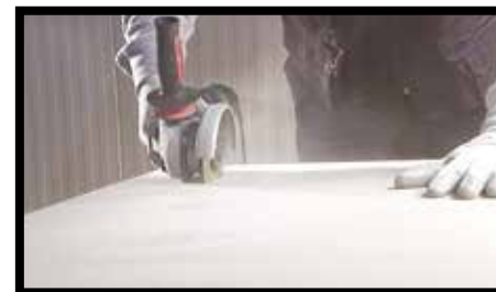
Fig.7 - SLIMTECH, in tutte le sue tipologie, può essere tagliata anche utilizzando dischi diamantati montati su smerigliatrici manuali elettriche. Risulta necessario procedere con elevate velocità di rotazione (> 10000 giri/min) e basse velocità di avanzamento (< 1 m/min). A seconda del tipo di disco e della lunghezza del taglio può essere necessario il raffreddamento ad acqua del disco stesso. I dischi più idonei risultano essere quelli sottili utilizzati per il taglio del gres porcellanato. I vantaggi di questo tipo di taglio consistono nella facilità di esecuzione manuale e nella possibilità di effettuare tagli in fase di posa.
