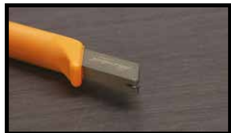
Fig.1 - Si possono ottenere tagli e sagomature eccellenti incidendo SLIMTECH nelle sue varie tipologie con coltelli da vetro (tagliavetro) tipo Silberschnitt 2000 Tagliavetro speciale della Bohle Italia o tipo tagliapiastrelle manuale della Würth . Per realizzare l'incisione è comunque importante non staccare il tagliavetro dall'asse di incisione durante l'intera operazione di lavorazione.
