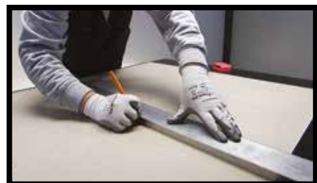
Fig.2 - Per rendere un'incisione la più rettilinea possibile si può ricorrere all'ausilio di stadi in alluminio comunemente usate dai muratori.
